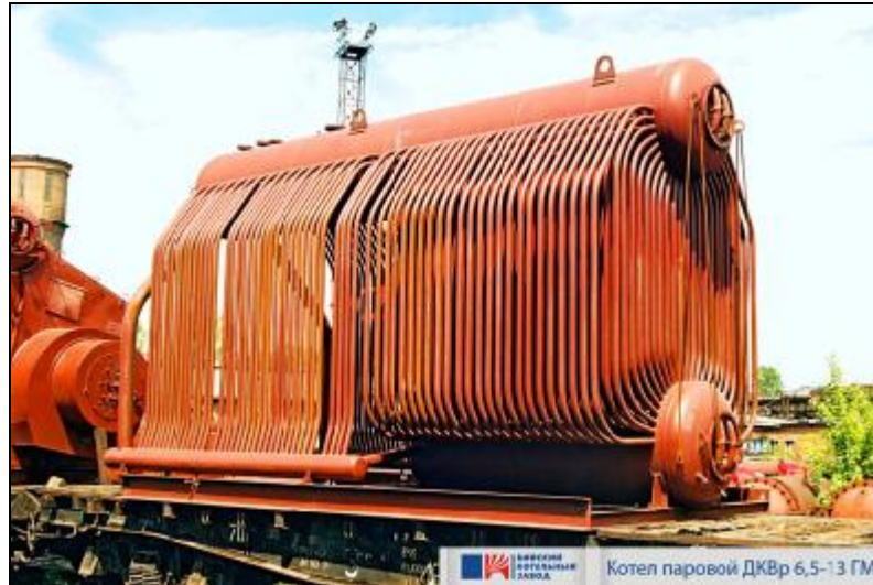
Рисунок 1.1. Фотографія парового котла ДКВр 6,5-13 ГМ
